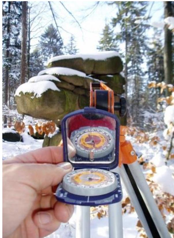
***Kuckuckstein:** Vermessung der Sichtöffnung mit Stellwinkel und Kompass: Linkes Bild = Maximaldurchblick östliche Richtung (Beobachter C); rechtes Bild= Maximaldurchblick westliche Richtung (Beobachter D).*
